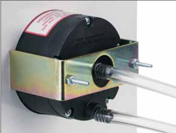
Для монтажа на панели в отверстия диаметром 67 мм вместе с измерителем MiniHelic® II поставляется монтажное оборудование. Поставляемое оборудование может использоваться для панели толщиной до 13 мм. Если есть необходимость, на задней стороне измерителя используют монтажную пластину, которая может иметь два 4-40 винта пропускаемых через отверстия в монтажном кронштейне. Эта монтажная пластина должна иметь отверстия для двух штуцеров.
